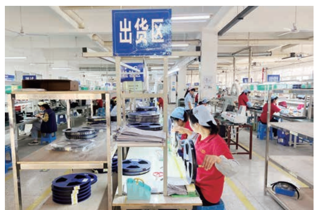
在汉中锐杰电子有限责任公司生产线，工人正在将合格的电感器真空封装装入载盘。
