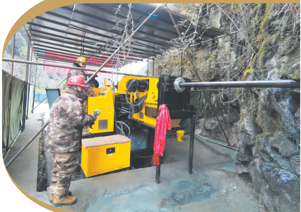
公司技术人员在川藏铁路勘察现场实施小口径超深定向水平孔钻探
